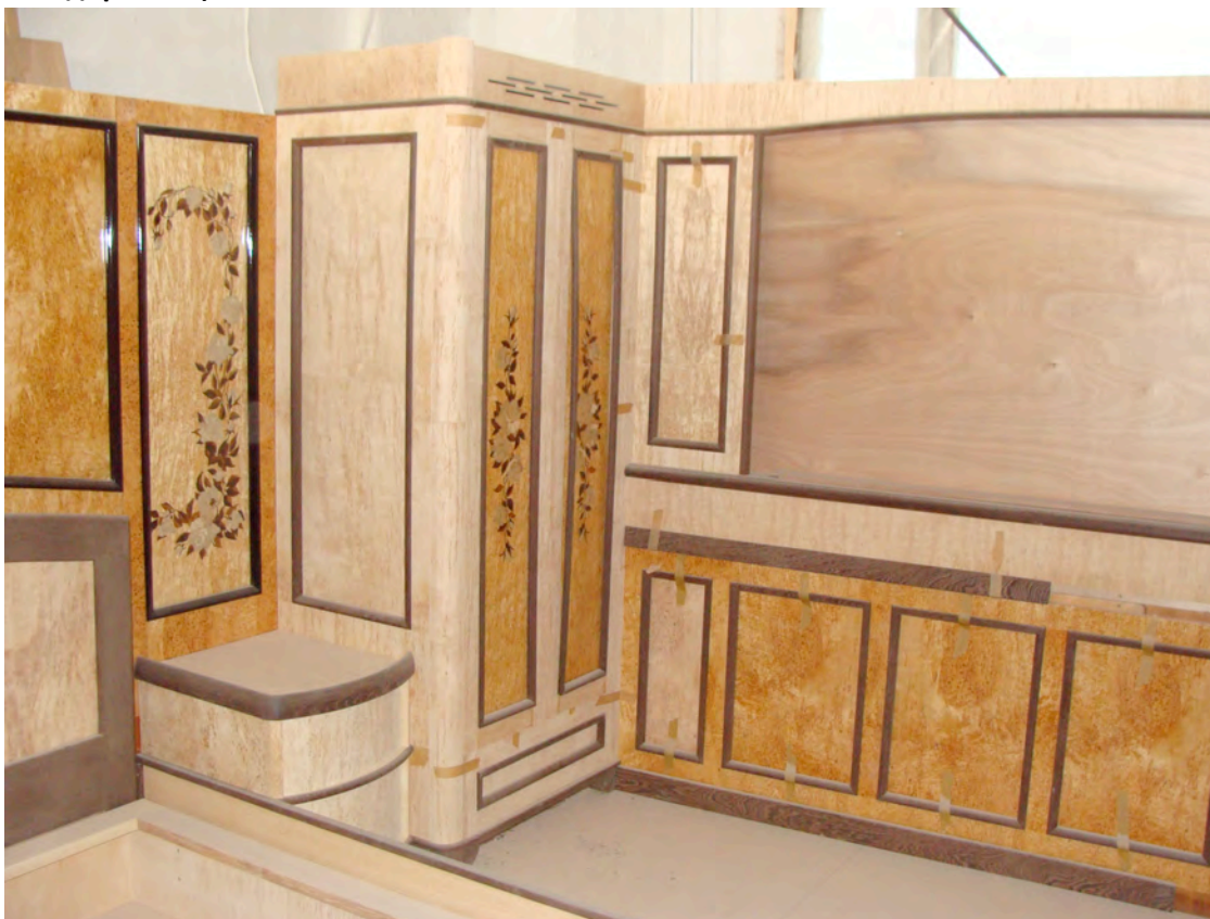
Отделка каюты Владельца – предварительная сборка в цехе (разобрана и складирована)
