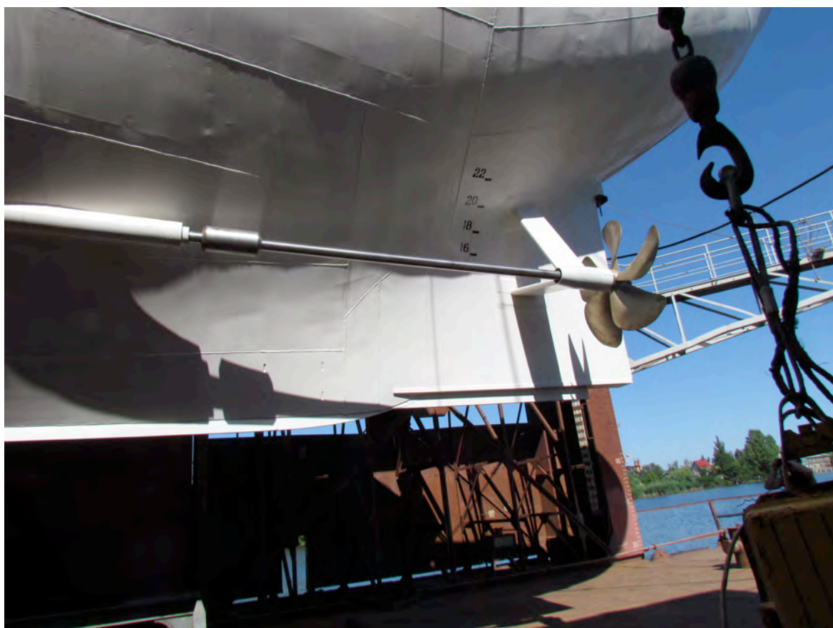
Валолинии с винтами – смонтированы и отцентрованы
