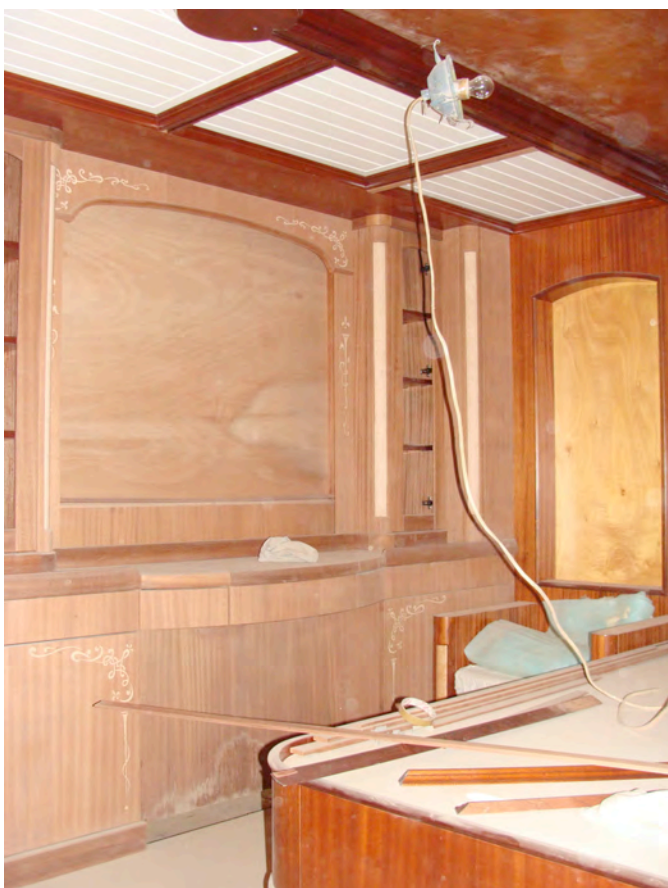
Гостевая каюта – предварительная сборка в цехе
